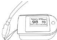
Slika 4 Namestittev nosilne vrvice
